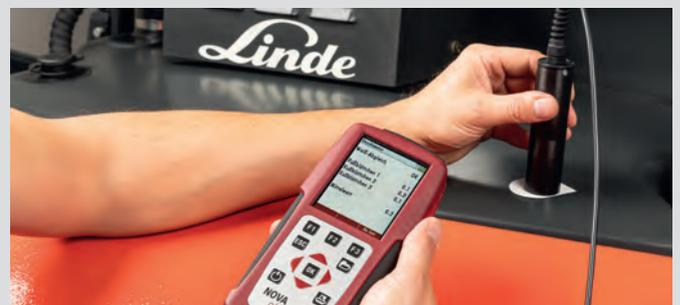
Zur Bestimmung der Schwärzungszahl (Bosch-Rußzahl) verfügt das NOVAplus FFZ über einen Densitometer, mit dem die Rußzahl punktgenau ermittelt wird.
