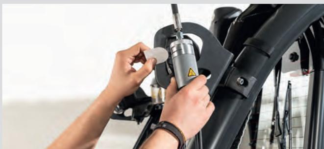
Kondensatbildung bei der Rußmessung wird durch Beheizung verhindert. Das erforderliche Abgasvolumen wird durch eine Regelung der Gaspumpe gewährleistet.
