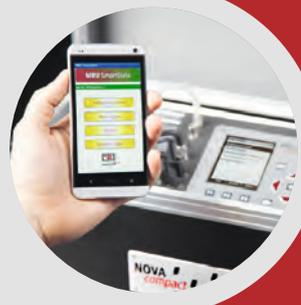
Messdaten speichern, übertragen und drucken SD-Karte, Mini-USB, Bluetooth™ für Datenübertragung auf Smartphone, Tablet oder PC.
